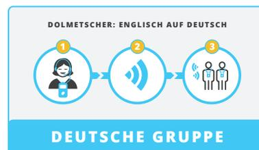
Dolmetscher können über ein ListenTALK-Gerät und ein Headset gleichzeitig die Originalsprache hören und für eine unbegrenzte Anzahl an Teilnehmern übersetzen, ohne dass zusätzliche Ausrüstung benötigt wird. Für das Relaisdolmetschen können ebenfalls Gruppen konfiguriert werden.
